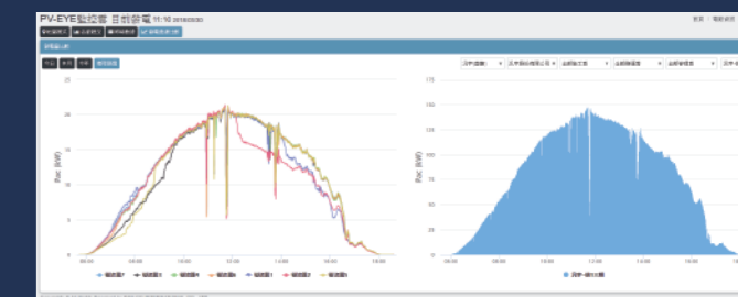
電廠/變流器發電曲線(日)比較
