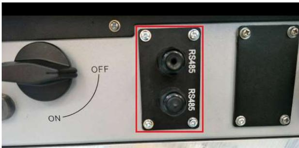
3.2 取出 WI-FI 預留之白色連接線材的下端。(上端已連接至電路板，請勿拉扯)，並請將白色線材與黑色 WI-FI 接受器做連接，並鎖回螺絲固定。(4 顆螺絲務必鎖緊，預防水或水氣進入，破壞防水等級)
